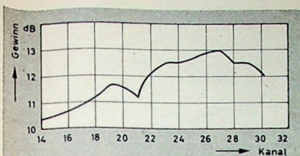
Bild 20. Gewinn einer Band-IV-Breitbandantenne mit 15 Elementen
